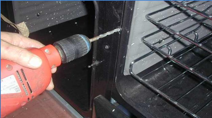
Oter l'ergot de fermeture et percer l'ancienne douille en utilisant un foret Ø 7 mm.
