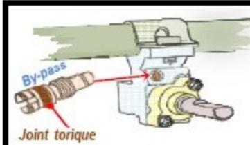
Les BY PASS ou VIS DE RALENTI équipent chaque robinet et sont calibrés suivant la puissance du brûleur. Lors du contrôle de tenue de flamme, le réglage du ralenti peut être ajusté en modifiant le serrage du by pass.
