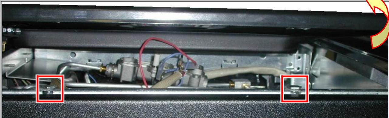
Débrancher les fils d'alimentation du chauffe plat avant de d'enlever complètement le table droite
