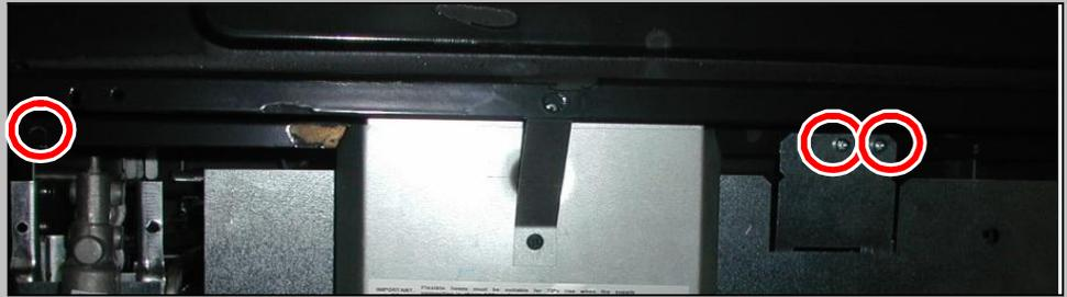
Démonter les 2 vis de fixation maintenant la table et les 4 vis fixant le corps de brûleur wok.
