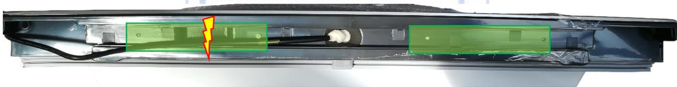
Couper le câble existant et souder le câblage HOM2695672 dans les zones indiquées. Positionner de la gaine thermorétractable (non fournie) pour isoler les fils avant de souder les fils en respectant les couleurs.
