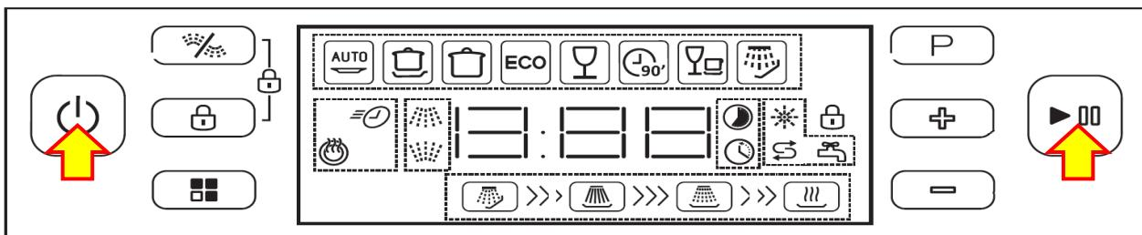
Auf den Selbsttest zugreifen, ziehen Sie den Stecker aus der Steckdose und schließen Sie ihn wieder ein.
