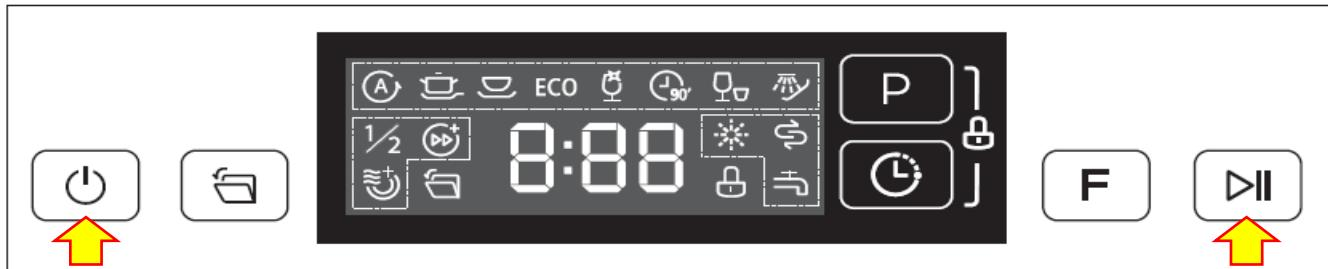
Para acessar o programa de teste, desconecte e conecte a máquina de lavar louça
