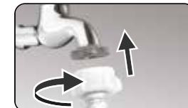
Raccordez le tuyau d'arrivée d'eau à la vanne d'arrivée d'eau et à un robinet d'eau froide, de la manière indiquée dans l'illustration.
