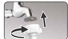
Sluit de watertoevoerslang aan op de watertoekoerklep en een waterkraan voor koud water, zoals aangegeven
