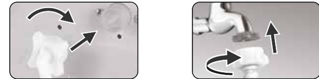
Raccordez le tuyau d'arrivée d'eau à la vanne d'arrivée d'eau et à un robinet d'eau froide, de la manière indiquée dans l'illustration.
