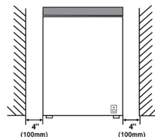
S'il est installé à côté d'une source de chaleur ou d'un réfrigérateur, respectez les dégagements latéraux minimums suivants :
