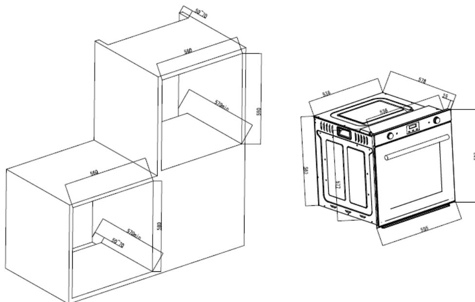
Assurez-vous que le four a été correctement fixé dans son cadre. La fixation du four dans le cadre de fait à l'aide de quatre vis. Celle-ci doivent être vissées à travers le meuble du four et dans son cadre.
