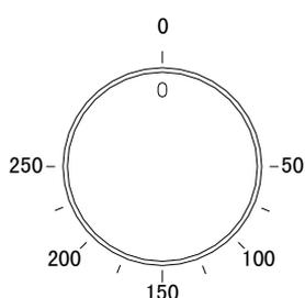
La molette de contrôle du thermostat du four permet de régler la température du four. Vous pouvez choisir une température entre 50 – et
