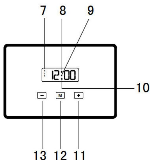
Après avoir connecté votre appareil à la source d'alimentation électrique pour la première fois (ou après une coupure de courant) les numéros sur l'affichage du minuteur clignoteront. Avant de sélectionner une fonction de cuisson ou de régler une température vous devez sélectionner le mode d'utilisation manuelle.
