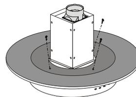
Fixez le toit en verre en appliquant les 4 sets de vis de "4x25mm", le coussinet de butée et la bague.
