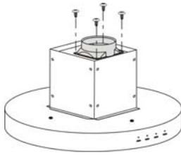
Installez la valve de sortie à la sortie d'air et fixez-la avec 4 vis de 4 x 8mm
