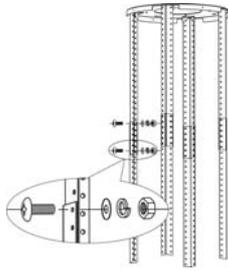
Attachez les 4 autres «barre angulaire en fer» pour construire la longueur totale (X) de la cheminée (comme décrit dans la section précédente), fixez-les avec les 16 sets de vis de 4 x 10mm, la bague, la rondelle à ressort et la rondelle.
