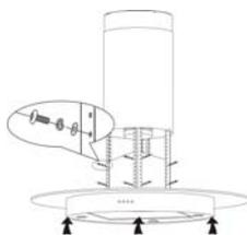
Attachez l'unité principale à la « barre angulaire en fer » (assurez-vous que le panneau de contrôle soit orienté vers la droite) et fixez-la avec 16 vis de 4 x 10mm, la rondelle à ressort et la bague.
