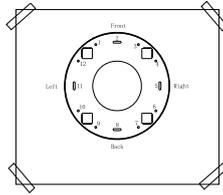
Collez le “patron d'installation du support de plafond” à l'endroit désiré (le mot “Avant” doit être orienté dans le même sens que le panneau de contrôle de la hotte).
