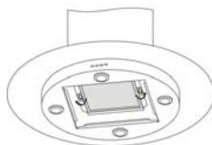
Fixez le filtre avec les 2 loquets fournis. Assurez-vous que le filtre est verrouillé en position, car autrement il pourrait causer des dommages. (en cas de ventilation interne)
