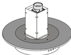
Installez le toit en verre sur l'unité principale en l'insérant par le haut de l'unité principale puis alignez les trous des vis.
