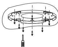
Installez le support de plafond et fixez-le avec les vis 6 x 40mm ou avec les vis explosives (comme décrit dans la section précédente).
