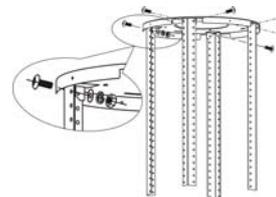
Attachez les 4 pièces de la “barre angulaire en fer” pour construire la base de la cheminée, fixez-la avec les 8 sets de vis de 4 x 10mm, la bague, la rondelle à ressort et la rondelle.
