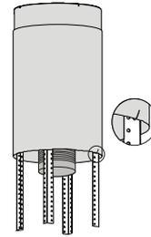
Maintenez la position de fonctionnement de la cheminée externe en l'attachant à la « barre angulaire en fer » avec le crochet fourni.
