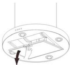
Avant de procéder à l'installation, enlevez le filtre anti-graisse de l'unité principale en appuyant sur le filtre pour le déverrouiller.
