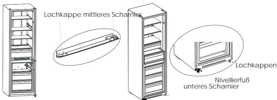
5. Lösen Sie die Schrauben, Hülsenrohr und Stopfen an der unteren Endabdeckung der beiden Türkörper und installieren Sie sie nacheinander auf der anderen Seite der Türkörper. Entfernen Sie dann die obere Endabdeckung der Kühltür und wechseln Sie das Kabelbaum mit einem Hülsenrohr auf die andere Seite des Türkörpers. Installieren Sie schließlich das Hülsenrohr des oberen Scharniers an der Kühltür in das Loch auf der anderen Seite der oberen Endabdeckung der Kühltür..
