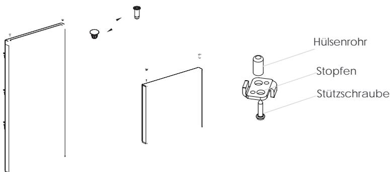
6. Setzen Sie die Gefriertür auf das untere Scharnier und installieren Sie das mittlere Scharnier, Lochkappen
