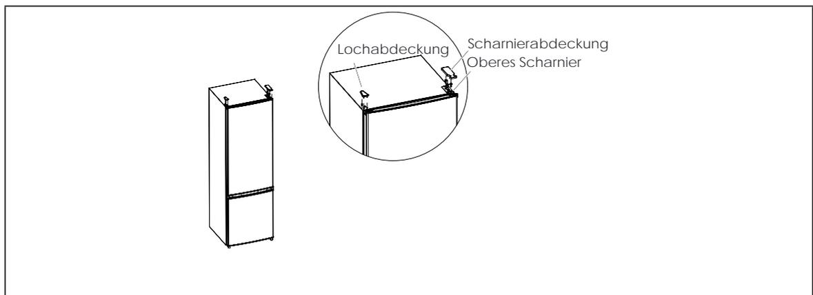
3. Nehmen Sie die Tür des Kühlraums, das mittlere Scharnier (verwenden Sie einen Kreuzschlitzschraubendreher, um die Schraube des mittleren Scharniers zu entfernen) und die Lochkappe auf der anderen Seite ab.
