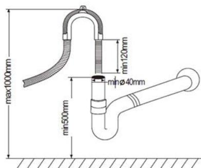
**IMPORTANT** : Les objets ne seront pas lavés correctement si un tuyau d'évacuation de plus de 4 m est utilisé.
