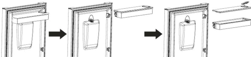
2. Après le nettoyage, repositionnez le réservoir d'eau, le couvercle et le bac du réservoir comme indiqué ci-dessous.
