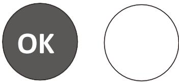
Si « OK » n'apparaît pas, la température de la zone est trop élevée. Réglez le thermostat sur une position supérieure. Attendez au moins 12 heures avant de réajuster le thermostat. Après le chargement des denrées fraîches dans l'appareil ou après les ouvertures répétées (ou ouverture prolongée) de la porte, il est normal que l'indicateur de température n'affiche pas « OK ».
