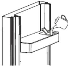
2. Remplissez le réservoir avec de l'eau potable et pure.
