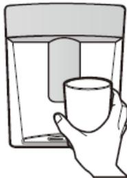
Pour stopper l'écoulement d'eau, retirez votre verre du levier distributeur.
