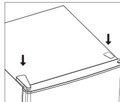
15. Vérifiez si le joint de porte est déformé. Si oui, détachez les joints de porte du réfrigérateur et du congélateur, puis fixez-les après rotation.
