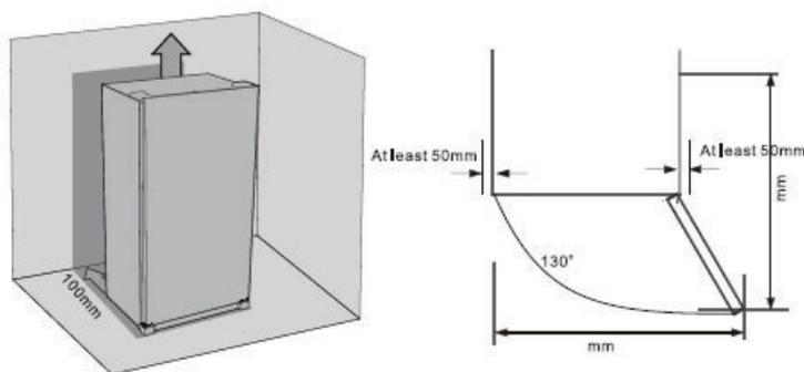
Installez cet appareil dans un endroit où la température ambiante correspond à la classe climatique indiquée sur la plaque signalétique de l'appareil:
