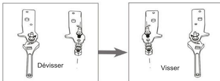
9. Installez la charnière sur le côté gauche et le pied sur le côté droit. Vissez ensuite deux pieds de nivellement avec leurs pièces d'origine.
