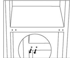
11. Relevez l'appareil et placez la porte sur la charnière inférieure. Assurez-vous que le noyau de charnière inférieur est inséré dans le trou de porte. Déplacez ensuite le cache du trou de charnière de la porte inférieure de gauche à droite.
