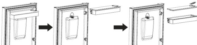
2. Après le nettoyage, repositionnez le réservoir dans le compartiment et le couvercle comme indiqué ci-dessous.
