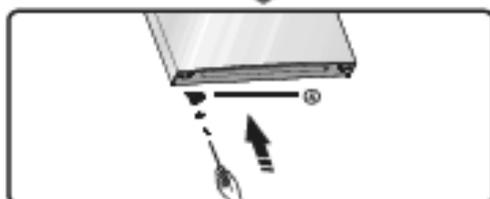
10. Changez de gauche à droite les couvercles des trous de vis sur la plaque de recouvrement centrale (comme indiqué sur la figure ci-dessous).
