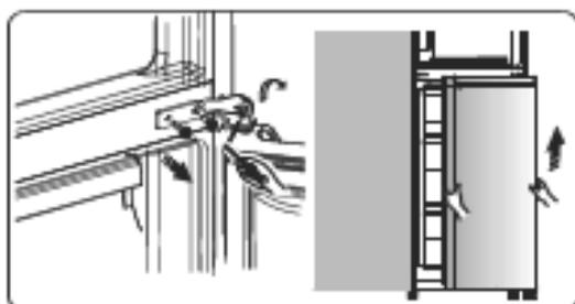
9. Placez la porte inférieure sur une surface lisse avec son panneau vers le haut. Desserrez la vis ③ et retirez les pièces ② et ①, installez la butée de porte de remplacement à gauche ④ (fournie dans le sac en plastique) et la pièce ② (bloc d'arrêt) sur le côté gauche à l'aide de la vis ③. Conservez la pièce ① avec l'appareil pour référence ultérieure.
