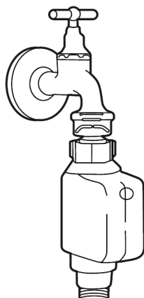
tuyau d'arrivée d'eau de sécurité
