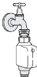
tuyau d'alimentation de sécurité
