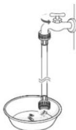
4. Raccordez fermement le tuyau à la valve d'arrivée d'eau à la main, puis serrez-le de 2/3 de tour avec une pince.
