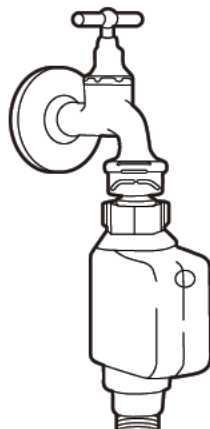
Tuyau d'arrivée d'eau de sécurité
