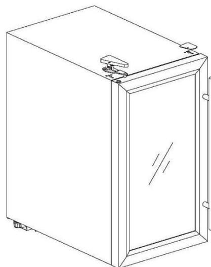
5) Installez la charnière de porte inférieure ⑤ sur le coin inférieur gauche. Placez la porte sur la charnière et insérez-la dans la charnière de porte inférieure.
