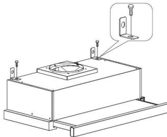
3. Die Dunstabzugshaube wird mit 4 Schrauben (4mm×30mm) und Dübeln an der Wand befestigt. Befestigen Sie die Dunstabzugshaube mit 2 Schrauben (4mm×30mm) und Dübeln an der Wand auf der Rückseite der Dunstabzugshaube. Befestigen Sie dann die Dunstabzugshaube mit 2 Schrauben (4mm×30mm) und Dübeln durch die kleine L-förmige Halterung an der Wand.
