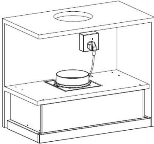
Wenn zwischen der Wand und der Dunstabzugshaube ein Spalt ist, können Sie die Halteplatte mit zwei Schrauben (3×12 mm) an der Unterseite der Haube anbringen. Der Einbau der Halteplatte ist optional.
