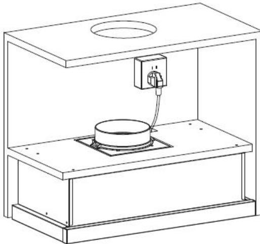
S'il y a un espace entre le mur et la hotte, vous pouvez installer la plaque de maintien sur la partie inférieure de la hotte à l'aide de deux vis (3×12 mm).
