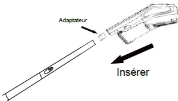
4. Attachez ensuite l'embout désiré (brosse de sol ou suceur plat) au nez du réservoir à poussière ou au bout du tube nécessaire.
