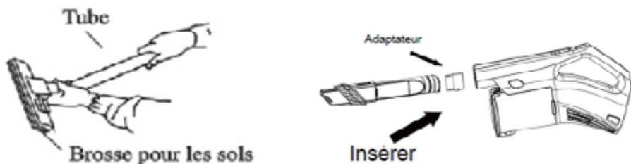
**ATTENTION:** Lorsque vous utilisez l'appareil avec le tube métallique, il faut tenir l'appareil par la poignée et éviter de s'appuyer sur le tube lui-même, cela risquerait de plier/casser le tube ou l'appareil et ce point n'est pas couvert par la garantie.
