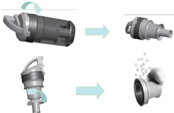
d. Nettoyez le fil de protection du moteur filtre environ une dizaine de fois lorsque vous le videz ou plus souvent si nécessaire. Nettoyez le filtre dans l'eau chaude, sans additifs. Mettre en place une seule fois qu'il est complètement sec.
