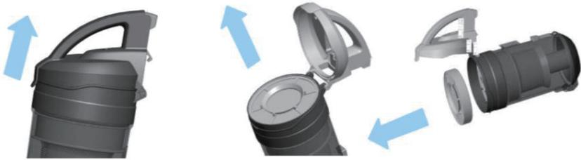
b. Suivez les images ci-dessous et faites pivoter le couvercle du réservoir vers la droite pour sortir le filtre à haute efficacité en plastique, et faire pivoter le couvercle du filtre dans le sens des aiguilles d'une montre pour le nettoyer.
