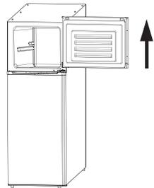
3. Demontieren Sie das mittlere Scharnier mit einem Schraubenzieher. Heben Sie die Tür nach oben, um sie aus dem unteren Scharnier zu lösen. Legen Sie die Tür vorsichtig auf eine gepolsterte Unterlage beiseite.
