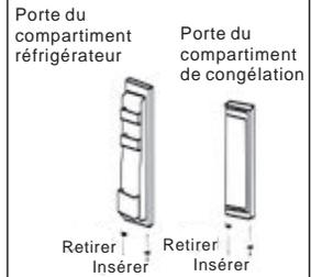
6. Setzen Sie die Kühlschrantür auf das untere Scharnier und achten Sie darauf, dass der Scharnierstift in das Loch an der Unterseite der Kühlschrantür eingeführt wird. Bringen Sie das mittlere Scharnier wieder am Schrank an und achten Sie darauf, dass es sich auf der gegenüberliegenden Seite der ursprünglichen Position befindet.
