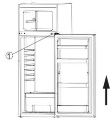
4. Tauschen Sie die Position des unteren Scharniers und des verstellbaren Fußes auf der anderen Seite des Schrankes aus.
