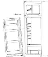
7. Setzen Sie die Kühlschrantür auf das mittlere Scharnier und achten Sie darauf, dass der Scharnierstift in das Loch an der Unterseite der Kühlschrantür eingeführt wird. Dann das obere Scharnier aufsetzen, auf die Tür richten und den Bolzen festschrauben, die linke Scharnierabdeckung abdecken und dann den Bolzen festschrauben.
