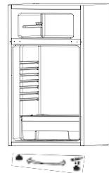
5. Entfernen Sie den Scharnierstift, der sich unten in der Kühl- und Gefrierschranktür befindet, und setzen Sie auf der anderen Seite der Kühl- und Gefrierschranktür den mit dem Gerät gelieferten Ersatzscharnierstift ein.
