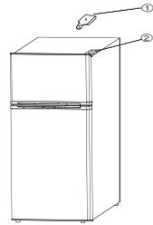
2. Heben Sie die Tür nach oben, um sie aus dem mittleren Scharnier zu lösen. Legen Sie die Tür vorsichtig auf eine gepolsterte Unterlage beiseite.
