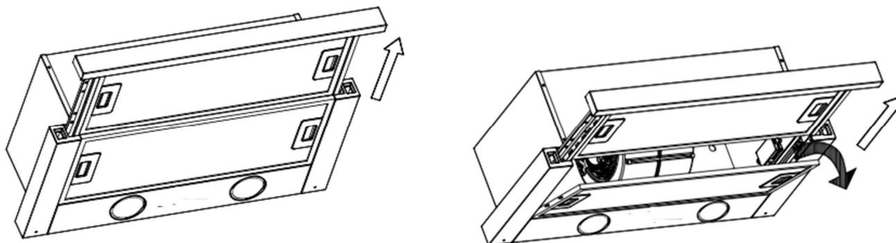
Installer le filtre à charbon actif dans l'appareil et tournez-le dans le sens des aiguilles d'une montre. Répétez l'opération de l'autre côté. En cas de remplacement, tourner le filtre dans le sens inverse des aiguilles d'une montre.
