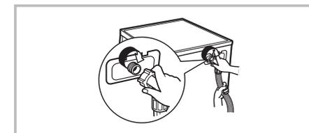
**Opmerkingen:** Eenmaal aangesloten en indien er lekkage aanwezig is, voer de aansluitprocedure voor de toevoerslang nogmaals uit. Voor aansluiting op het water, maak gebruik van de meeste courante soort kraan. Als de kraan vierkant of te groot is, vervang deze door een standaard kraan.
