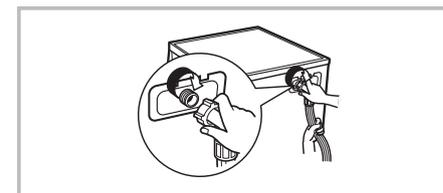
**Remarques :** après avoir effectué le raccordement, s'il y a des fuites au niveau du tuyau, effectuez à nouveau la procédure de raccordement du tuyau d'alimentation. Pour l'alimentation en eau, utilisez le type de robinet le plus courant. Si le robinet est carré ou trop grand, faites-le changer par un robinet standard.
