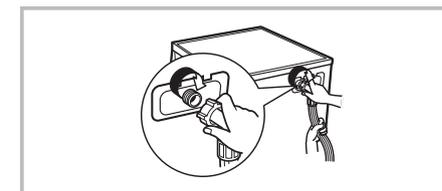
**Observaciones:** una vez efectuada la conexión, si existen fugas en el tubo, vuelva a realizar la conexión del tubo de suministro. Para el suministro de agua, utilice el tipo de grifo normal. Si el grifo es cuadrado o demasiado grande, cámbielo por uno de estándar.
