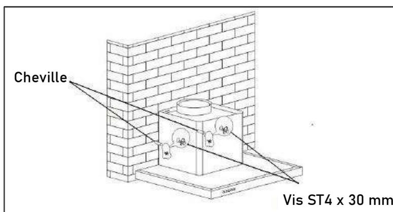
5. Dans le cas d'une installation en évacuation, installer le clapet anti-retour sur la bouche d'évacuation. Installer le tuyau d'évacuation (non fourni) et serrer avec un serre câble (non fourni)
