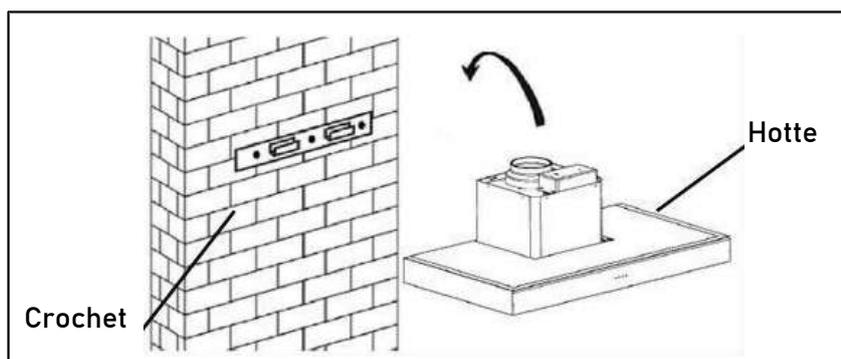
4. Après avoir accroché la hotte au crochet, retirer les filtres à graisse et marquer deux trous à l'intérieur de la hotte pour les vis de sécurité. Après le marquage, retirer la hotte, percer deux trous et insérer deux chevilles, puis visser les vis de sécurité à l'aide de deux vis (ST4x30 mm).
