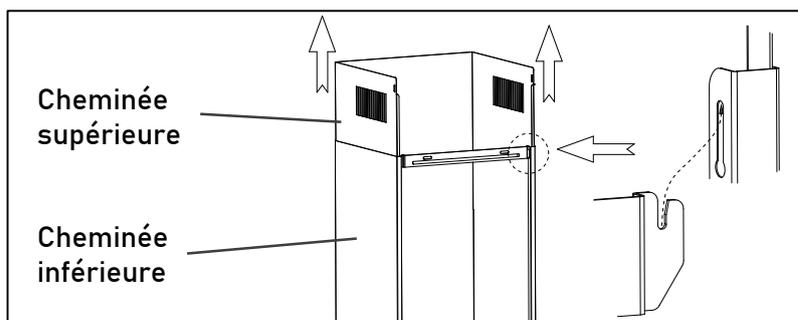
7. Percer deux trous 8 mm de diamètre pour installer le support de fixation. Visser et serrer le support sur le mur avec les 2 vis fournies ST4x30mm. Assembler la cheminée sur l'unité et la fixer avec 2 vis 4x8mm.
