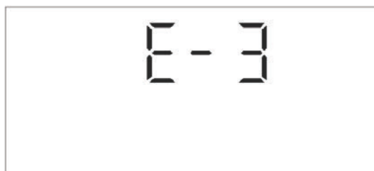
Imagen 12: Aspecto de la pantalla de la alarma de bloqueo anómalo de la puerta
