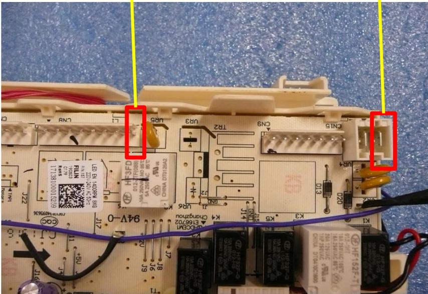
Contrôle de l'alimentation en 230 V~AC par le module de puissance du moteur inverter:
