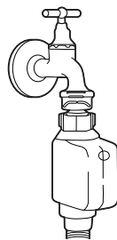
tuyau d'arrivée d'eau de sécurité
