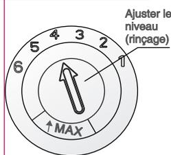
Le distributeur de liquide de rinçage offre six ou quatre réglages.
