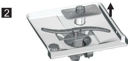
Etape 2: Soulevez l'assemblage du système du filtre.
