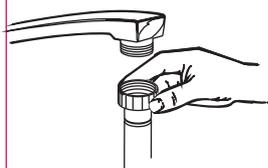
Connectez le tuyau d'alimentation d'eau froide à un connecteur fileté de  $\frac{3}{4}$  (pouces) et assurez-vous qu'il soit solidement attaché en place. Si les tuyaux d'eau sont neufs ou n'ont pas été utilisés durant une longue période, laissez couler l'eau pour vous assurer que l'eau est claire, sans impuretés. Si cette précaution n'est pas prise, il peut y avoir un risque que l'arrivée d'eau soit bloquée et qu'elle endommage l'appareil.
