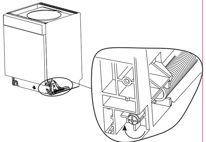
Ajustement de la tension des ressorts de la porte
