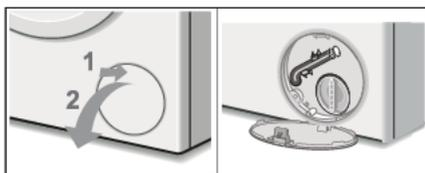
2. Retirez le bouchon du tuyau et placez le tuyau sur le côté du récipient et laissez l'eau finir de s'écouler du tambour. Une fois la vidange terminée, replacez le bouchon d'étanchéité à l'extrémité du tuyau et remettez le tuyau à son emplacement de stockage.
