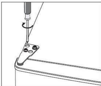
9. Vérifiez l'alignement horizontal et vertical de porte et vérifiez que les joints adhèrent parfaitement en tout point de l'encadrement. Si tout est correct, terminez de serrer toutes les vis de charnière. Remontez le couvercle de la charnière du haut et le cache vis. Le cas échéant, ajustez les pieds réglables.
