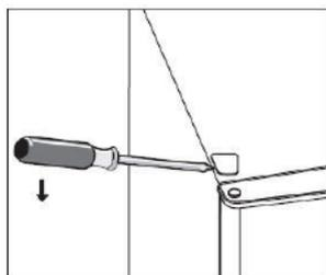
4. Déplacez le cache du côté gauche vers le côté droit. Puis, soulevez la porte supérieure et placez-la sur une surface rembourrée pour qu'elle ne se raye pas.
