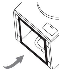
1. Posez la machine sur le sol, en mettant un matériau souple comme de la mousse ou des vêtements entre la machine et le sol.
