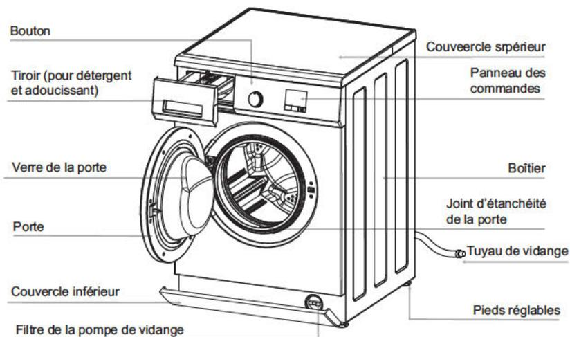
Remarque : Dévissez le filtre de la pompe de vidange pour laisser l'eau s'écouler lorsque la machine n'est pas utilisée pendant une longue période.
