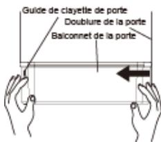
Démontage : Tenez les deux côtés du balconnet de la porte avec les deux mains. Poussez-la du côté où il n'y a pas de guide et poussez-la vers l'intérieur, comme indiqué sur la figure, jusqu'à ce que le bord du balconnet soit séparé de la rainure de la doublure.
