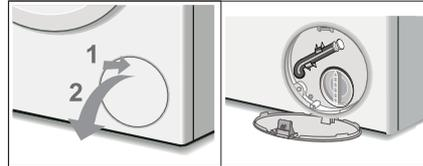
2. Retirez le bouchon du tuyau et placez le tuyau sur le côté du récipient et laissez l'eau finir de s'écouler du tambour. Une fois la vidange terminée, replacez le bouchon d'étanchéité à l'extrémité du tuyau et remettez le tuyau à son emplacement de stockage.
