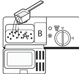
1. Appuyez sur le loquet de dégagement du distributeur de détergent pour ouvrir le couvercle.
