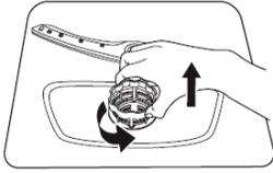
Tenez le filtre grossier et tournez-le dans le sens inverse des aiguilles d'une montre pour déverrouiller le filtre. Soulevez le filtre et retirez-le du lave-vaisselle.
