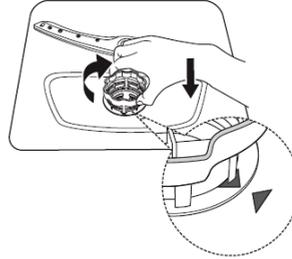
Remontez les filtres dans l'ordre inverse du démontage, remettez l'insert du filtre et tournez-le dans le sens des aiguilles d'une montre vers flèche indiquant la fermeture.
