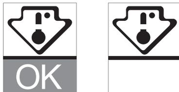
Si "OK" n'apparaît pas, la température de la zone est trop élevée. Réglez le thermostat à une position plus élevée. Attendez 12 heures avant de vérifier à nouveau. Après le chargement de nourriture fraîche dans l'appareil ou après des ouvertures répétées (ou prolongées) de la porte, il est normal que le mot "OK" n'apparaisse pas dans l'indicateur de température.
