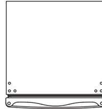
2. Retirer le couvercle de charnière et la charnière supérieure avec un tournevis, puis retirer la porte.
