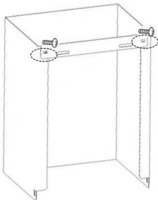
Étape 5. Installez la cheminée inférieure dans l'appareil, puis marquez la position des trous sur le mur.
