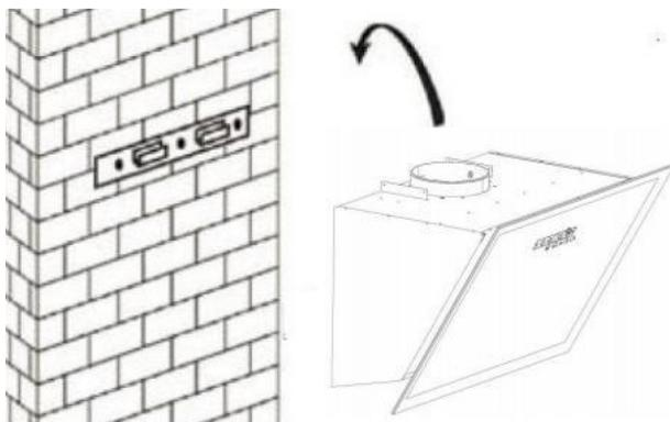
Étape 3. (Si le mode d'installation d'extraction est choisi) Placez le tuyau d'évacuation Ø150-Ø153mm (fourni) sur la sortie d'air, comme indiqué ci-dessous. Si la taille de votre tuyau d'évacuation est de Ø120 - Ø123mm, vous devez d'abord monter l'adaptateur fourni sur la sortie d'air, comme indiqué ci-dessous.
