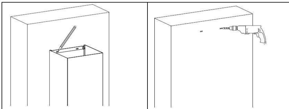
Étape 7. Installez à nouveau la cheminée inférieure sur l'appareil, puis vissez-la au mur à l'aide de 2 vis de diamètre  $\Phi$  4 mm et les chevilles (non fournies) correspondantes. Baissez également la cheminée et le capot avec 2 vis (ST4x8mm)
