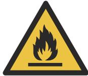
constitue un avertissement et indique que le réfrigérant et le gaz de soufflage de l'isolant sont inflammables.
