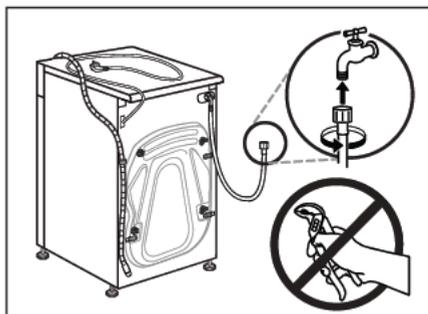
2. Connectez l'autre extrémité du tuyau d'alimentation en eau à la vanne d'entrée d'eau à l'arrière de l'appareil et serrez - la à la main.
