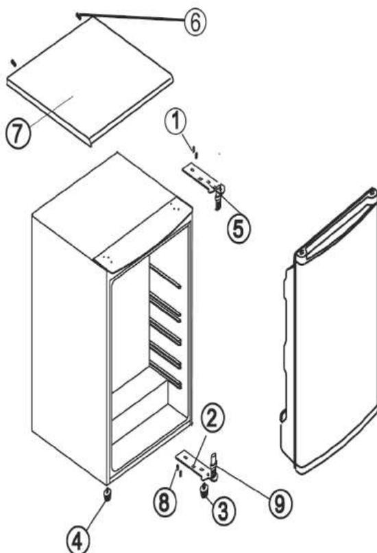
1. Retirez les deux vis (6) à l'arrière du couvercle supérieur. Puis retirez le couvercle supérieur (7) en le soulevant à l'arrière et en le glissant doucement vers l'avant.
