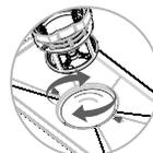
**C** Après nettoyage, le filtre à cylindre doit être assemblé dans le sens des aiguilles d'une montre jusqu'à la marque triangulaire du filtre, en même temps que le filet filtrant en l'acier inoxydable.
