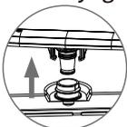
**A** Retirez le panier principal de l'appareil et soulevez un peu le bras de pulvérisation inférieur pour le déclipser.
