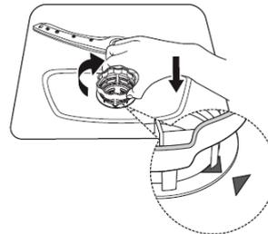
Remontez les filtres dans l'ordre inverse du démontage, remettez l'insert du filtre et tournez-le dans le sens des aiguilles d'une montre vers flèche indiquant la fermeture.
