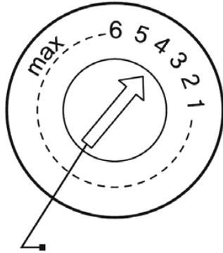
Tournez la molette de l'indicateur du liquide de rinçage sur un chiffre compris entre 1 et 6. Plus le chiffre est élevé, plus le lave-vaisselle utilise de liquide de rinçage. Si la vaisselle ne sèche pas correctement ou
