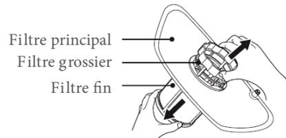
Le filtre fin peut être retiré du bas du dispositif de filtration. Le filtre grossier peut être détaché du filtre principal en appuyant délicatement sur les pattes de la partie supérieure et en le retirant.
