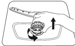
Tenez le filtre grossier et tournez-le dans le sens inverse des aiguilles d'une montre pour déverrouiller le filtre. Soulevez le filtre et retirez-le du lave-vaisselle.
