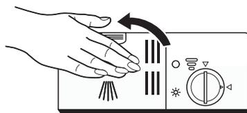
3. Fermez le couvercle et appuyez dessus jusqu'à ce qu'il se verrouille en place.
