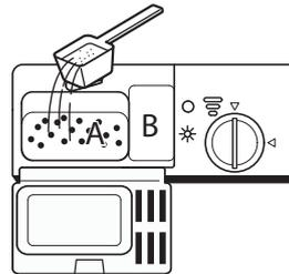
2. Ajoutez du détergent dans la grande cavité (A) pour le cycle de lavage principal. Pour la vaisselle très sale, ajoutez également du détergent dans la petite cavité (B) pour le cycle de prélavage.
