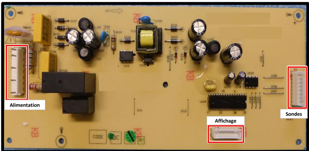
Avec la platine nouvelle version, il n'est plus utile de brancher le transformateur, celui-ci doit être retiré.
